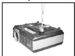
Fixati bratul proiector(5) cu suruburile (17)
